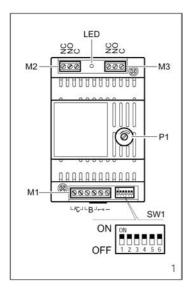
VLS/300 releyksikköä käytetää x2 ja 300-sarjan väyläpohjaisissa järjestelmissä. Yksikkö sisältää kaksi erillistä relettä, joita voidaan käyttää oven aukaisuun ja muuhun ohjaukseen. Relettä 1 voidaan käyttää ulkopuolisen laitteen ohjauksessa tai ovenaukaisutoiminnassa "master" tai "slave" toimisena. Releen 1 vetoaika voidaan säätää 1-16s. (säädin P1). Rele 2 toimii ainoastaan "Master" tilassa ja sen vetoaika on kiinteästi 1s.
